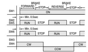
1. RUN에서 STOP으로 하면 제동 (전기 BRAKE)이 약 0.5초간 동작하여 MOTOR가 급속으로 정지합니다.
