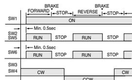
1. RUN에서 STOP으로 하면 제동 (전기 BRAKE)이 약 0.5초간 동작하여 MOTOR가 급속으로 정지합니다.
